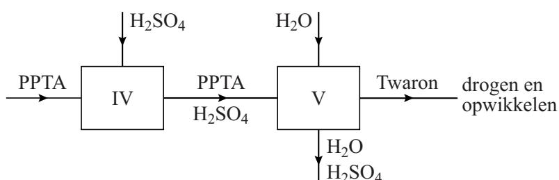
In ruimte IV wordt PPTA opgelost in zuiver zwavelzuur. In ruimte V wordt de oplossing van PPTA in zwavelzuur geëxtrudeerd tot Twaron-vezels.
