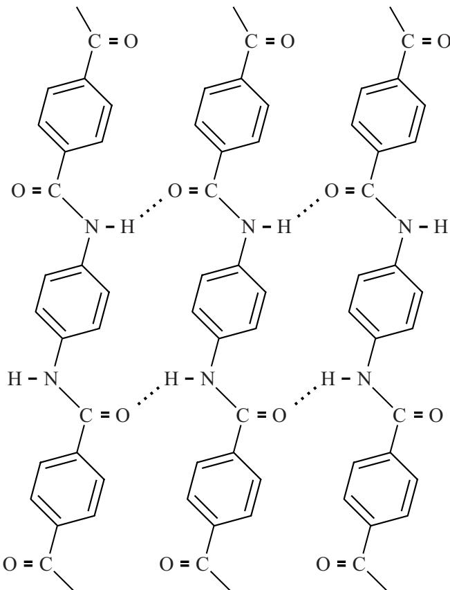
Met name deze bindingen geven Twaron zijn bijzondere mechanische eigenschappen. Behalve de waterstofbruggen zijn er nog twee andere bindingstypen aanwezig in Twaron.
